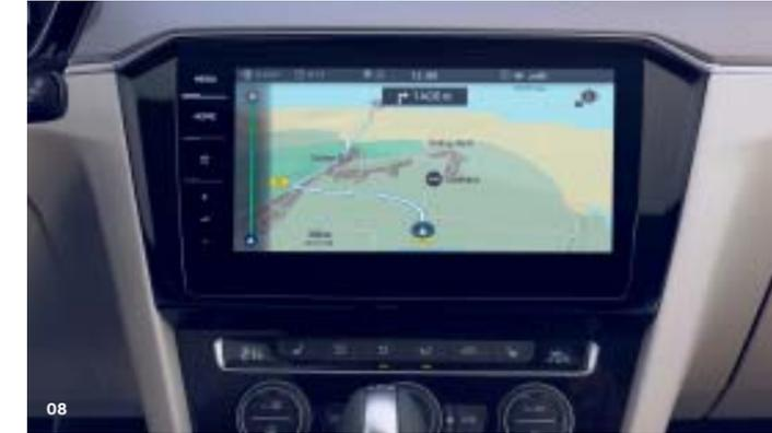
**08** Das Navigationssystem „Discover Pro“ mit mobilen Online-Diensten von We Connect\* lässt sich mit seinem 23,4 cm (9,2 Zoll) großen, glasüberbauten TFT-Touchscreen mit Farbdisplay, Gestensteuerung und natürlicher Sprachbedienung intuitiv und komfortabel bedienen. Das System verfügt außerdem über eine Verkehrszeichenerkennung sowie über App-Connect Wireless (für Apple CarPlay™). Acht Lautsprecher sorgen nicht nur beim digitalen Radioempfang über DAB+ für ein optimales Klangerlebnis. **SO**
